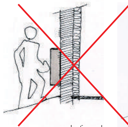
Élément non intégré à la façade
